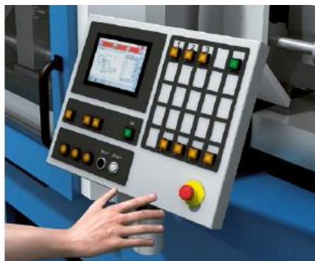
شکل ۶-۷. دکمه توقف اضطراری قارچی شکل که باید به وضوح قابل تفکیک و دسترسی باشد
