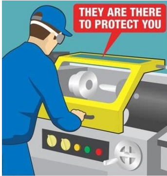
شکل ۴-۸. بدون نصب کامل همگی حفاظها، هرگز ماشین افزار را روشن نکند
