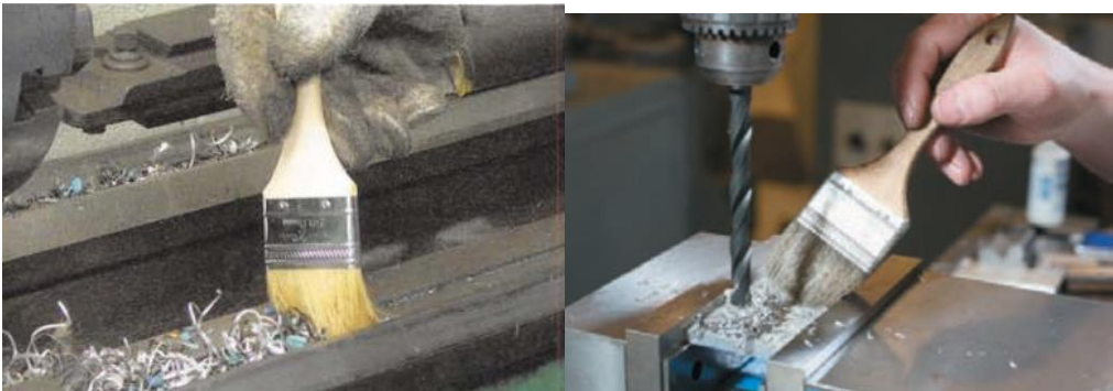
شکل ۱-۱۲. برای برداشتن براده‌های جمع شده از برس استفاده کنید و هرگز این کار را با دست انجام ندهید.
