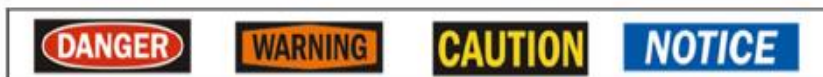
شکل ۴-۹. نمونه ای از علائم هشدار خطر که معمولاً بر روی تجهیزات در ناحیه خطر نصب می شود
