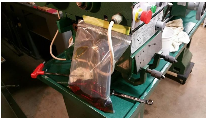
شکل ۳۱-۳. نحوه تعویض روغن گیربکس سرعت ماشین تراش
