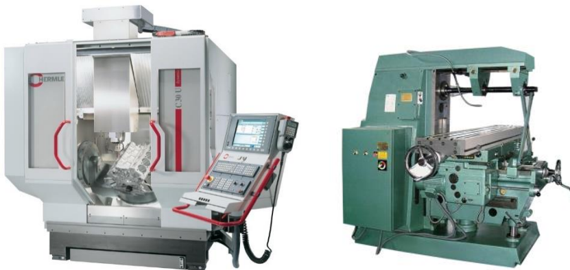
شکل ۲-۲۳. ماشین فرز انیورسال در سمت راست و ماشین فرز کنترل عددی در سمت چپ نمایش داده شده است
