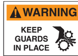
شکل ۴-۸. بدون نصب کامل همگی حفاظها، هرگز ماشین افزار را روشن نکند
