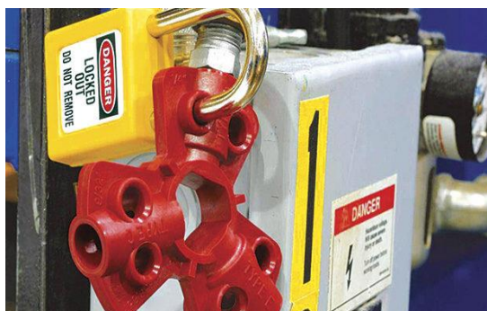
قفل و قلاب ویژه شیر پروانه ای قفل و قلاب ویژه برای نوعی جعبه برق
