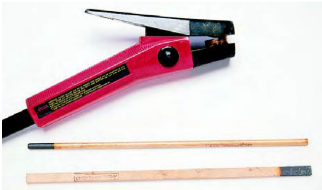
شکل ۱-۱۱: الکتروگیر و الکترودهای به‌کاررفته در فرایند برشکاری با الکترو کربنی و هوا
