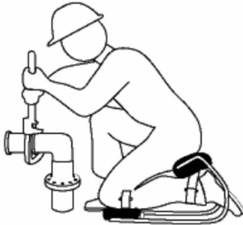
شکل ۹-۴: صندلی برای جوشکاری در وضعیت زانو زده
