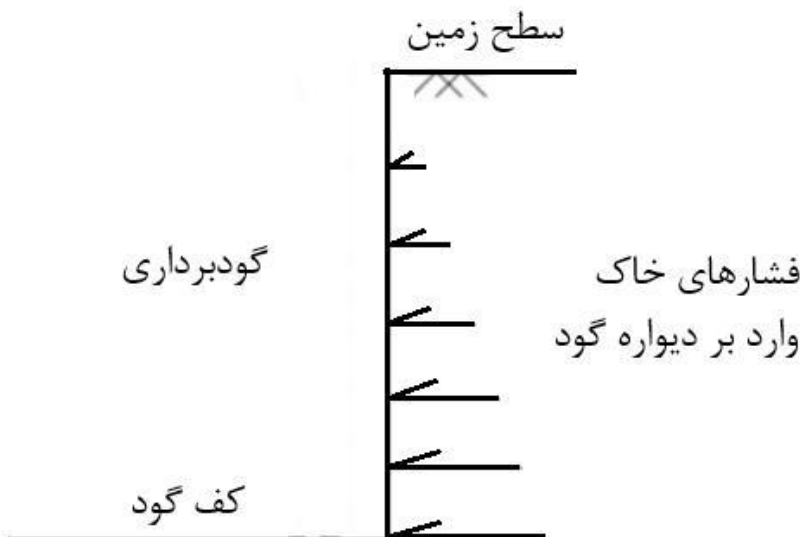
شکل ۱-۵. فشار جانبی وارد بر دیواره گود
