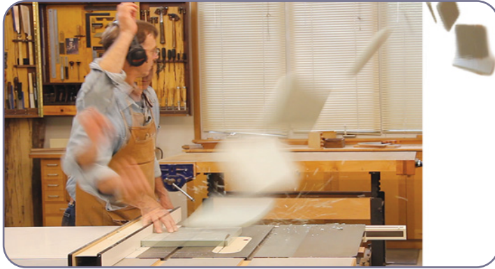
شکل ۵-۵. لگد اره (پرتاب قطعه کار به عقب در حین برش)
