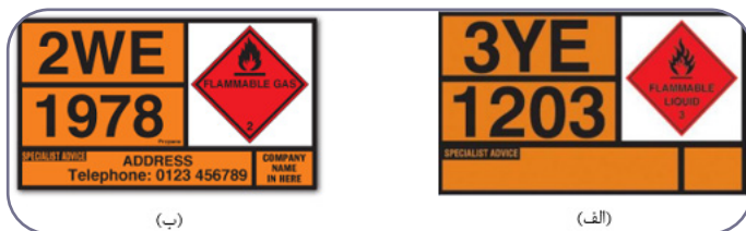
شکل ۳-۵. صفحه Hazchem برای مخزن حاوی بنزین (الف) و مخزن حاوی گاز پروپان (ب)
